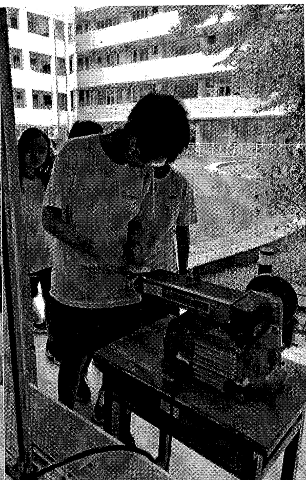
說明：用砂磨機砂磨湯匙，讓湯匙的形狀更加完美的呈現。
